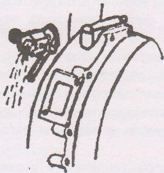
Рис. 11 Слив охлаждающей жидкости после остановки дизеля
