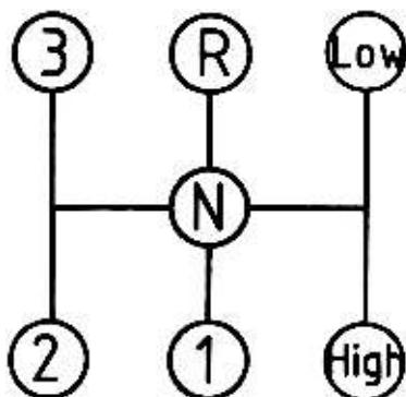
Рис. 2. Схема переключения передач КПП типа (3 вперед + 1 назад) х2.
