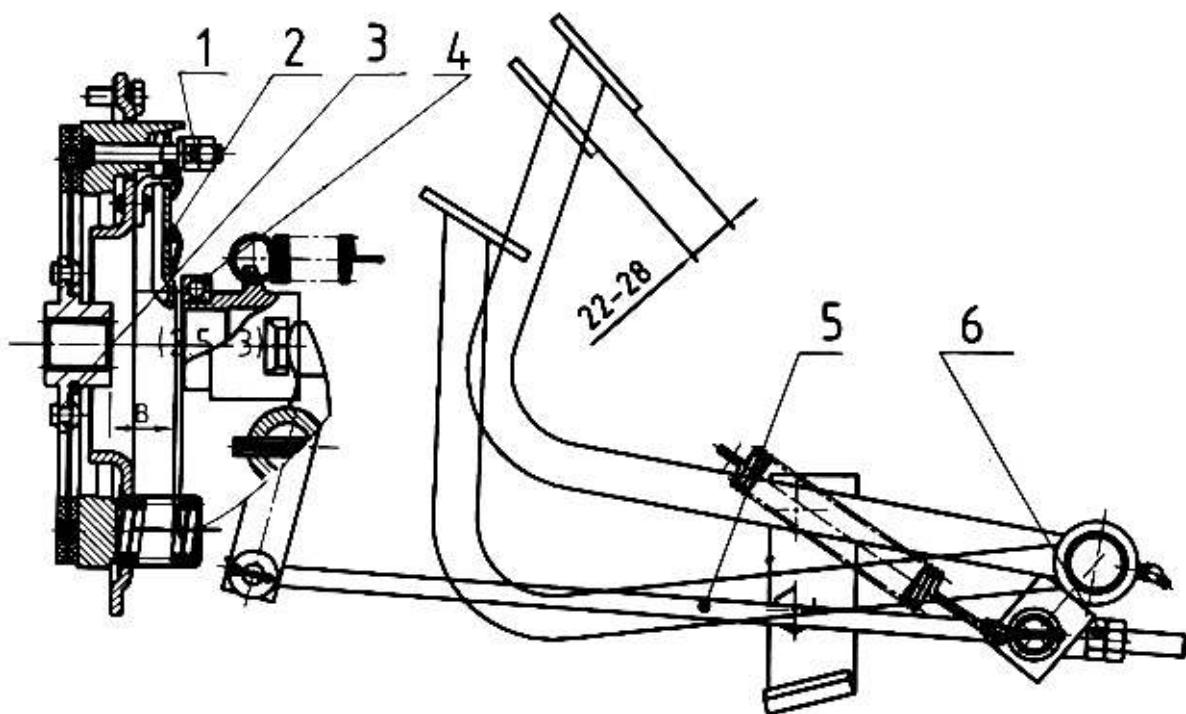
Рис. 4. Механизм сцепления.
