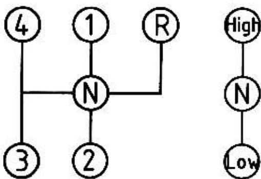
Рис. 3. Схема переключения передач КПП типа: (4 вперед + 1 назад) х2.
