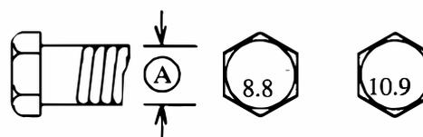
Значения, указанные выше, используются для несмазанной резьбы, если не указано дополнительно. При использовании стопорных элементов увеличивайте значение затяжки на 5%.
