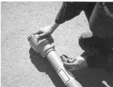
Демонтаж защитного кожуха
