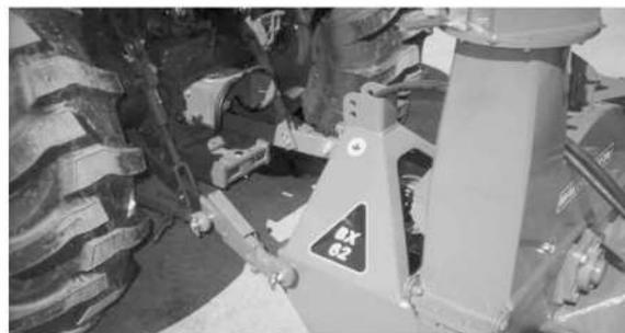
Рис. 17. Нижние рычаги в зацепленном состоянии.
