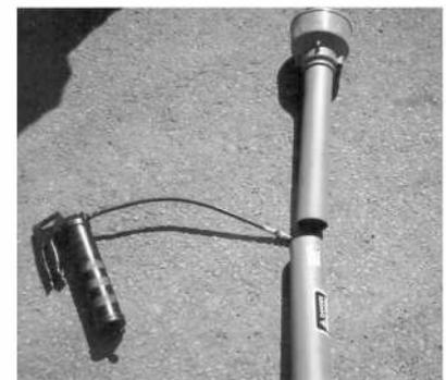
Смазка телескопической секции
