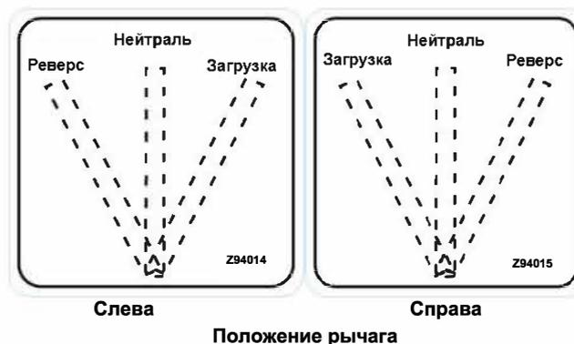
Рис. 22. Рычаг управления загрузкой.
