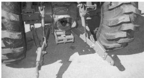
Рис. 16. Нижние рычаги трактора.
