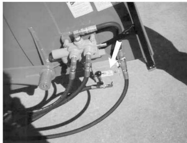
Рис. 24. Регулятор потока.
